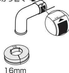
Aの丸パイプ蛇口の場合、コチラを切り取ってパイプ径を測定してください。
